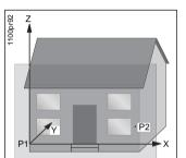
Un plano vertical se define con dos puntos. El eje X tienen como origen P1, es horizontal y positivo hacia la derecha (visto desde el instrumento).
