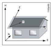
Un plano inclinado se define por 3 o más puntos. El eje Z lo determina la máxima inclinación, el eje X es perpendicular a él y horizontal, y el eje Y lo define el vector normal a ambos.
