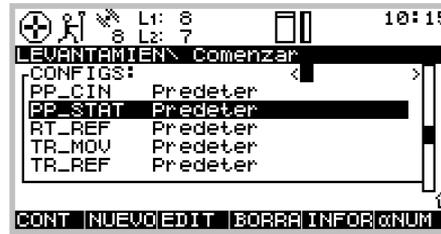
Utilice las teclas hacia arriba o hacia abajo del cursor para colocarse en la línea **PP\_STAT**. Oprima la tecla **ENTER** o **F1** CONT.
