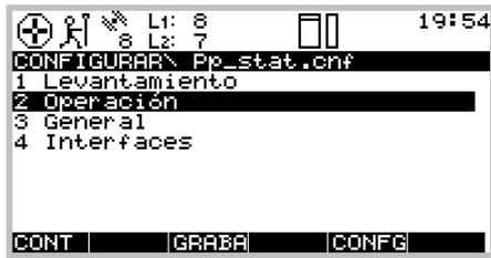
Es muy sencillo desplazarse y tener acceso a cada uno de los parámetros en forma individual: Puede oprimir los números (por ejem. **2** para Operación), o emplear las teclas hacia abajo / arriba del cursor, para colocarse en la línea de interés y oprimiendo después la tecla **F1** CONT.
