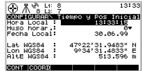
Utilizando la tecla hacia abajo del cursor, colóquese sobre el campo "Huso horar." y mediante las teclas hacia la izquierda / derecha del cursor, seleccione la zona de interés. O bien, oprima la tecla **ENTER** para desplegar el cuadro de lista con todas las opciones posibles.
