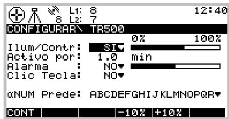
Pueden activarse o apagarse la iluminación y el nivel de contraste de la pantalla de la terminal, empleando la "tecla hacia la izquierda del cursor" para cambiar entre Sí y No. En caso de seleccionar Sí, defina la duración: una vez cumplido el plazo, la iluminación se desactiva nuevamente.
