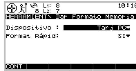
Si desea dar formato a la tarjeta PC, simplemente oprima **F1 CONT**. Pero si desea dar formato al módulo de memoria interna, oprima **ENTER**. Se despliega entonces un cuadro de lista, a partir del cual puede seleccionar dicho dispositivo.
