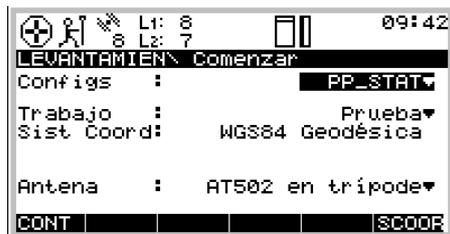
La selección de la Configuración, el Trabajo y el tipo de Antena se hace a partir de una lista existente.
