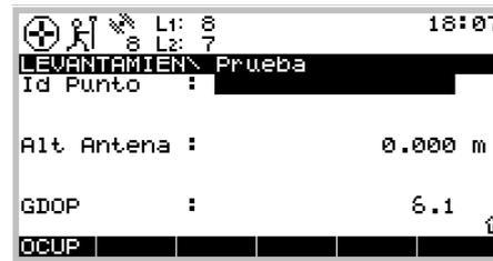
En esta, se deben ingresar dos datos: el Id de Punto y la Altura de Antena. Utilice las teclas hacia arriba / abajo del cursor para colocarse en el campo de interés. En este ejemplo, se puede escribir el Id de Punto.
