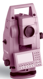
Taquímetro motorizado con seguimiento automático del prisma (TCA)
