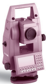
Taquímetro con distanció- metro para medidas sin reflector (TCR)
