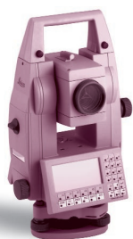
Taquímetro motorizado para medidas sin reflector (TCRM)
