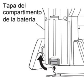
2. Compruebe dónde se encuentran los bornes de la batería e introduzca la batería tal como se muestra en la imagen.
